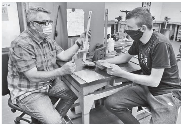
Bei der Berufsorientierung für Zugewanderte im BTZ steht die Praxis im Vordergrund: Ausbilder Daniel Epprecht (links) erklärt Vasileios Lazis, wie man eine Anreibnadel verwendet. Mithilfe von Anreibnadeln werden Werkstücke mit Maßstäben versehen. Zum Beispiel um Löcher zu bohren. Foto: Birgit Woitke
